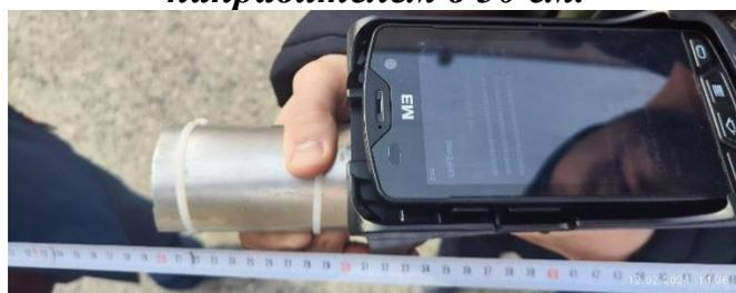
**Рис.3. Определение фактора направленности с алюминиевым направителем длиной в 15 см.**
