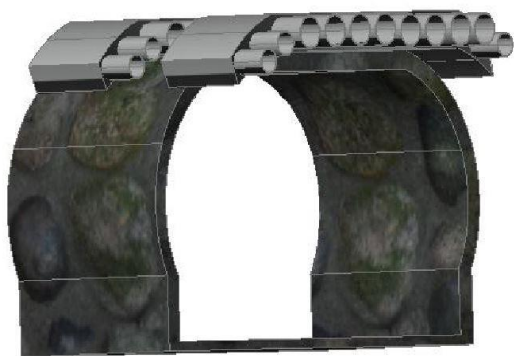
1-rasm. Suvchan lahimda polimer qoplamani yuqoriga joylashish holati.
