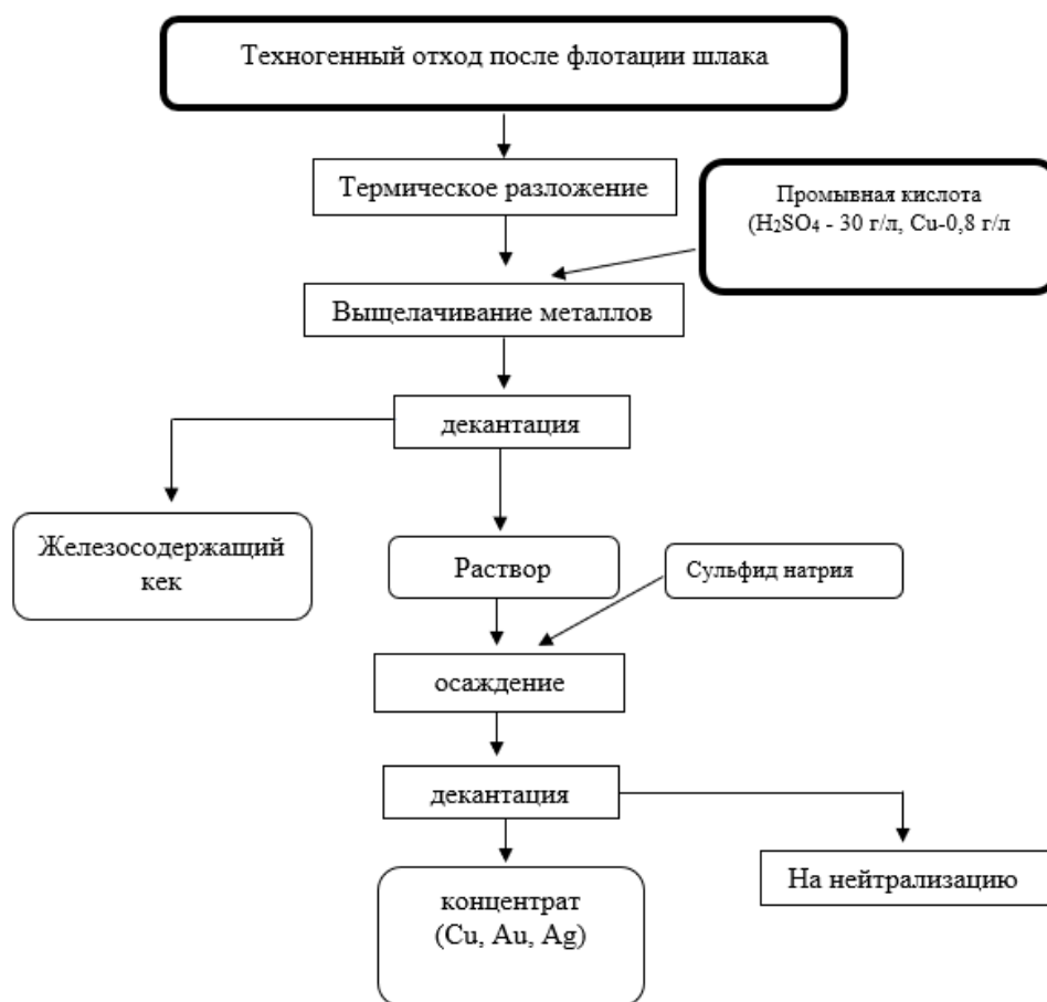
Рисунок 1. Технологическая схема извлечения меди из техногенных отходов после флотации медных шлаков
