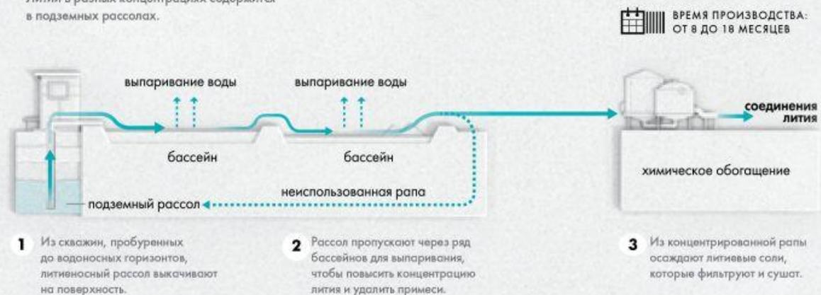
**1** Из скважин, пробуренных до водоносных горизонтов, литиеносный рассол выкачивают на поверхность.
