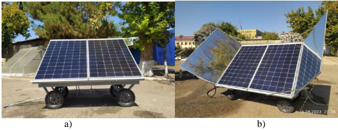
2-rasm. Suv chiqaruvchi mobil fotoissiqlik qurilmaning tajriba kunida olingan rasmlari. a) FEB rejimida, b) FIB rejimida.
