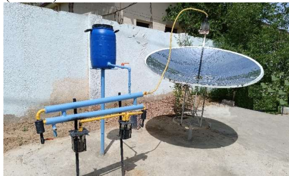
1-rasm. Quyosh konsentratorli geliopiroliz qurilmasi.
