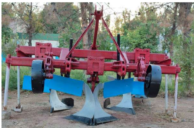
4-rasm. Yopiq va yarim ochiq kesish sharoitida egatsiz tekis shudgorlaydigan plugning tajribaviy nusxasi Sinovlardan olingan natijalar 2-jadvalda keltirilgan.
