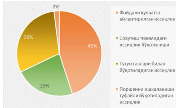
1-расм. Дизель электр станцияси ички ёнув двигателининг иссиқлик кўринишидаги энергия йўқотилишлари
