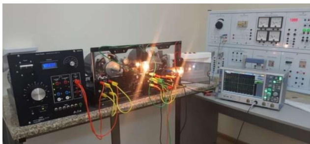
3-расм. Фаза роторли асинхрон генераторни текшириш учун йиғилган физик модел
