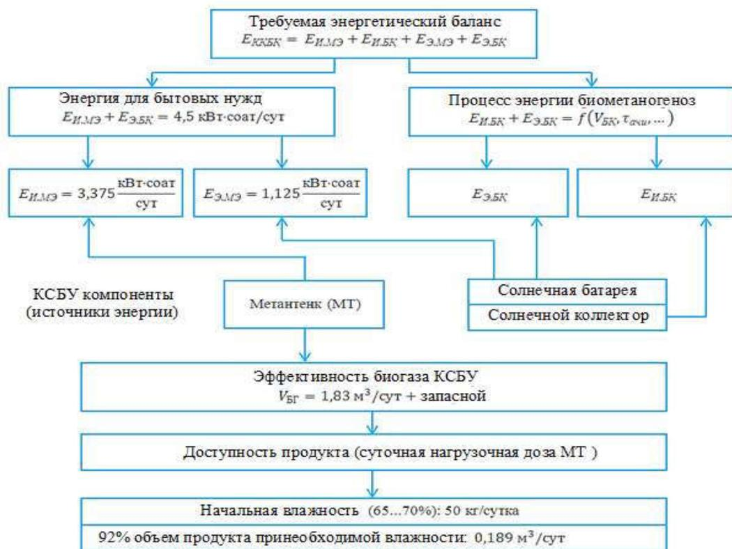
Рис.3. Питание напрямую от КСБУ, принципиальная схема.
