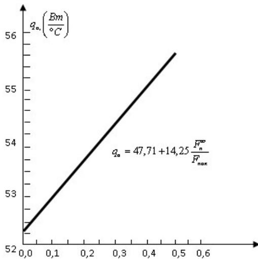
Рис.2. Зависимость удельной тепловой характеристики отапливаемого помещения ( $q_0$ ) от отношения  $\frac{F_n^{ю}}{F_{пол}}$ .
