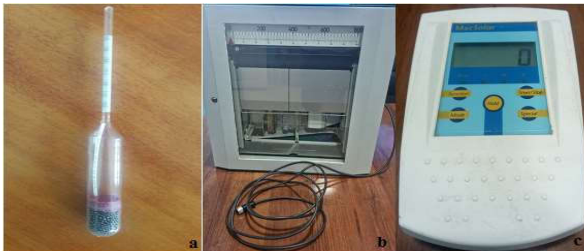
4-расм. Ўлчаш учун ишлатилган асбоблар. а) туз концентрациясини ўлчагич (ареометр), б) ҳарорат ўлчагич (КСП-4), с) қуёш энергиясини ўлчагич (актинометр)
