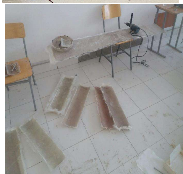
1-rasm. Mahalliy tolalarni sinash va bu tolalardan foydalanib turbina qismlarini tayyorlash jarayoni.
