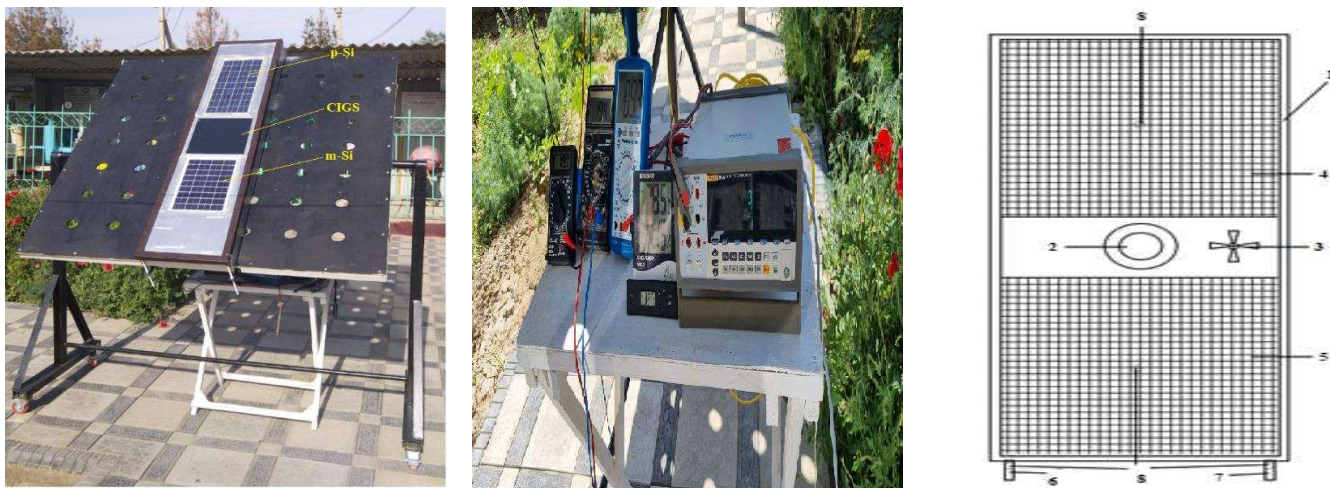
1-rasm. Tabiiy sharoitda m-Si, p-Si, CIGS quyosh elementlarning fotoelektrik va foto-issiqlik o'zgartirgichlarni parametrlarini o'lchash uchun eksperimental qurilmasi.
