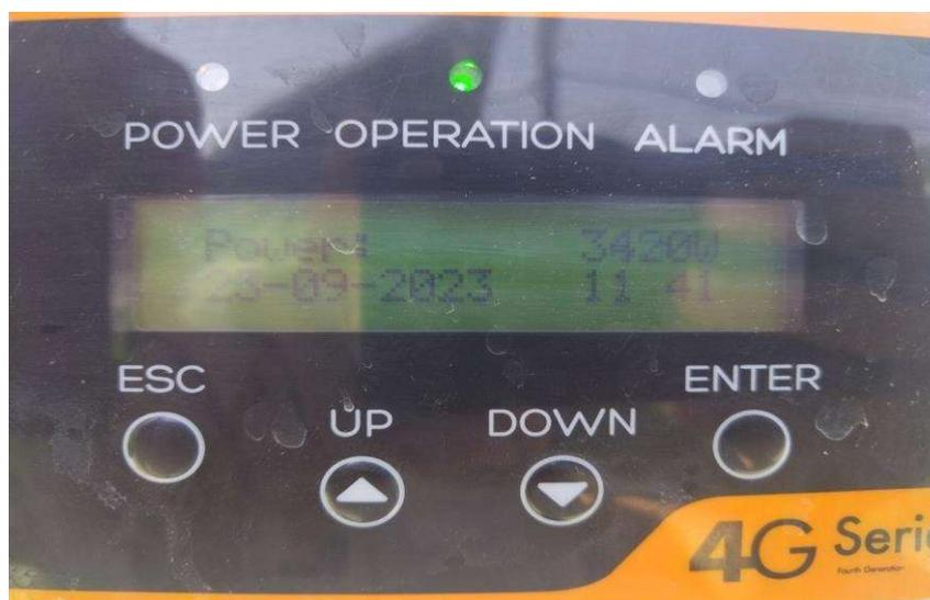
**Рис.3. Электрическая мощность солнечной фотоэлектрической установки мощностью 5 кВт, покрытой пылью и песком.**
