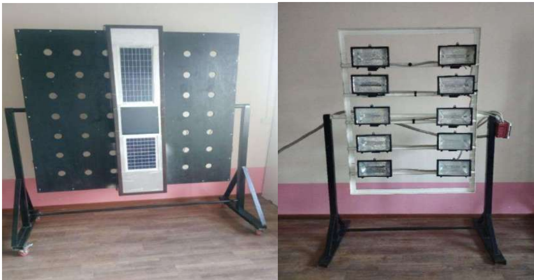
5-rasm. Yarim shaffof va shaffof fotoelektrik panellar tatajriba jarayonida quyosh semulyatoridan foydalangan holda BIFP tizimining fotosuratlari.
