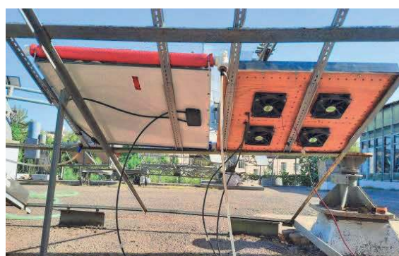
1-расм. ФЭБ ва ФИБ ни ҳаво ва сув орқали совутиш жараёни.
