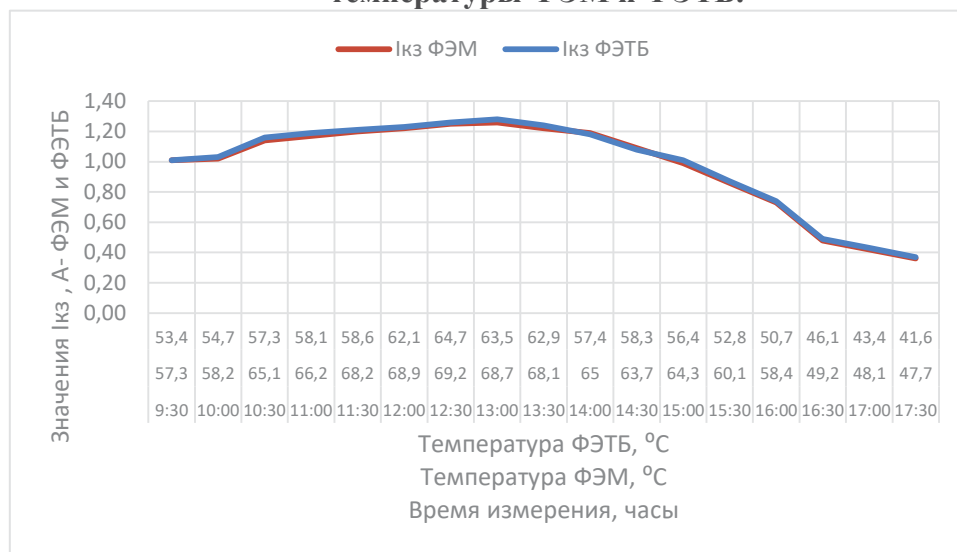
Рис.5.График изменения значений Ixz в течение дня в зависимости от температуры ФЭМ и ФЭТБ.
