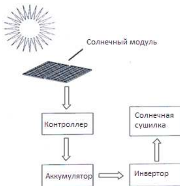
Рис.2. Блок-схема автономного электропитания сушилки.
