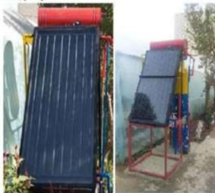
6-rasm. Kombinatsiyalashgan quyosh suv-havo qizdirish kollektorli va aralash issiqlik almashtirgichli gelioqizdirish qurilmasining umumiy ko'rinishi.
