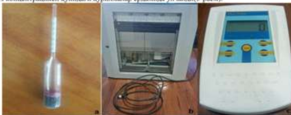
5-расм. Ўлчаш учун ишлатилган асбоблар. а) туз концентрасиясини ўлчагич(ареометер), б) ҳарорат ўлчагич (КСП-4), с) қуёш энергиясини ўлчагич(актинометер)
