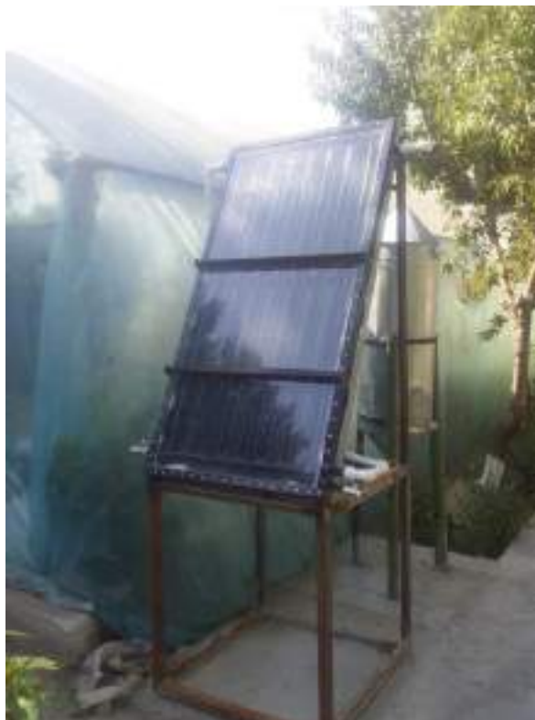
Рис.11. Экспериментальная установка водо-воздушного коллектора
