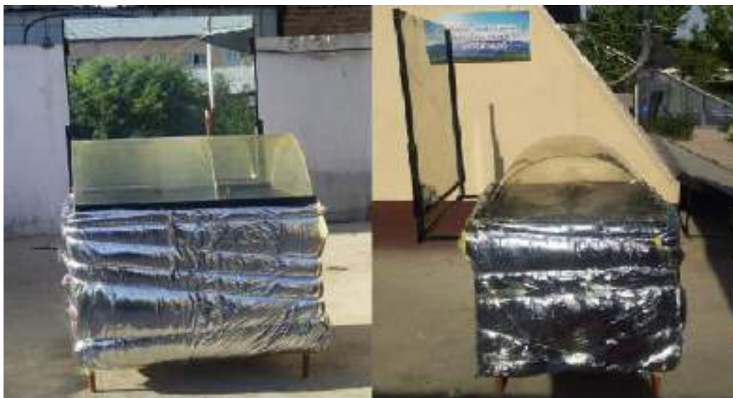
Рис.12. Экспериментальная солнечная установка для термической переработки твердых бытовых отходов
